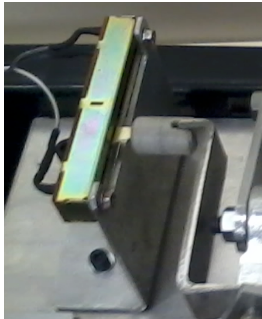
Figura 32 - Potenciômetro acoplado à haste do pistão
