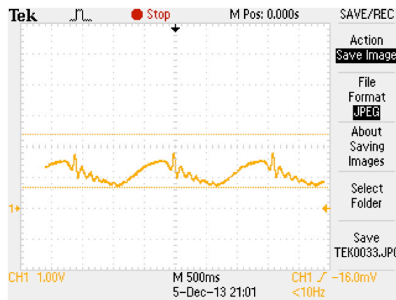
Figura 41 - Leitura do sensor de pressão na saída da bomba feita com o osciloscópio no teste de variação da coluna de água no reservatório de complacência. Teste realizado com nível alto da coluna de água
