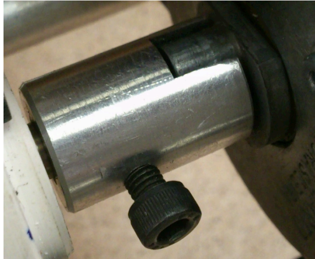
Figura 30 - Acoplamento entre o eixo do motor e o prolongamento do eixo
