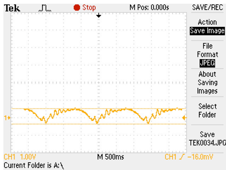
Figura 42 - Leitura do sensor de pressão na saída da bomba feita com o osciloscópio no teste de variação da restrição na saída do reservatório de complacência. Teste realizado sem restrição
