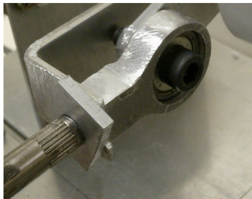
Figura 26 - Detalhes da peça que acopla haste à biela
